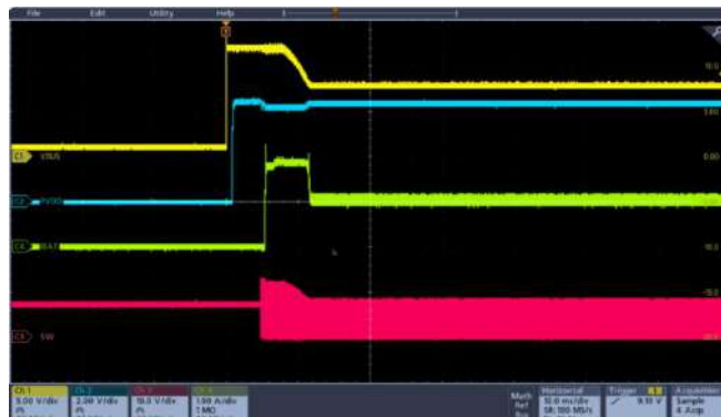
图 10-6 VBUS 启动时进入 VINDPM VBAT = 7.4V, ICHG = 2A, 插入 12V/1A VBUS
