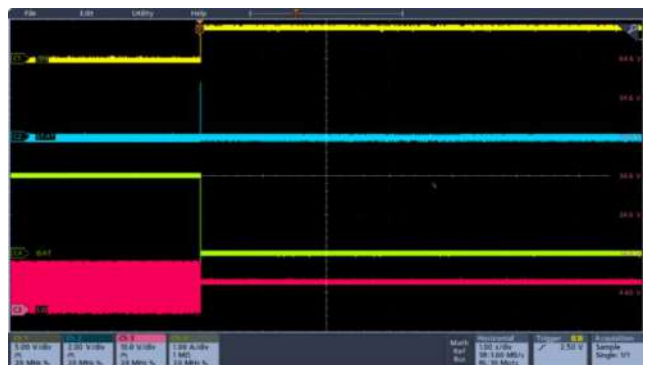
图 10-4 EN 禁止充电 VBUS = 12V, VBAT = 7.4V, ICHG = 2A
