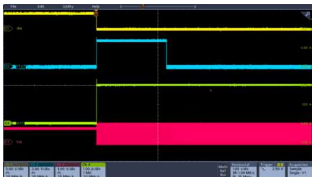
图 10-3 EN 启动充电 VBUS = 12V, VBAT = 7.4V, ICHG = 2A
