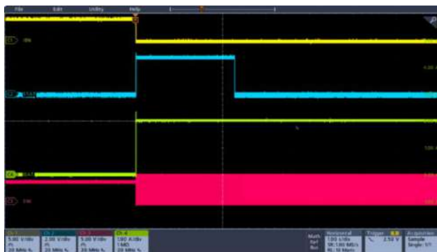
图 10-3 由 EN 管脚触发的充电使能 V_{BUS} = 5V , V_{BAT} = 3.7V , ICHG = 2A
