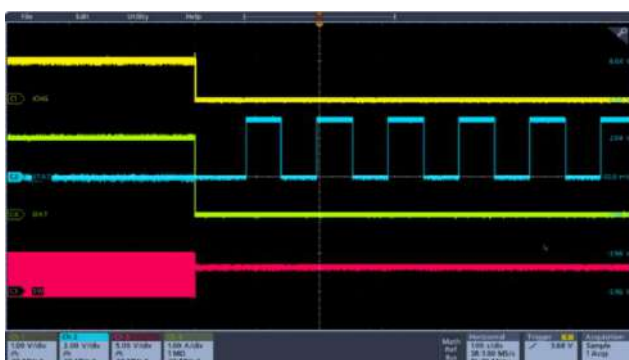
图 10-8 将 ICHG 短路到地以禁止充电 VBUS = 5V, VBAT = 3.7V, ICHG = 2A
