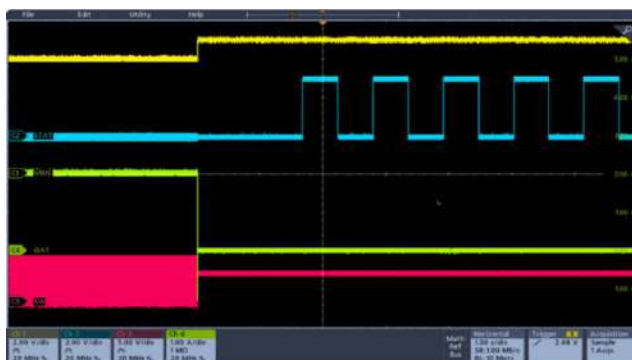
图 10-7 VBUS OVP VBUS = 6V, VBAT = 3.7V, ICHG = 2A, VBUS 突变到 7V
