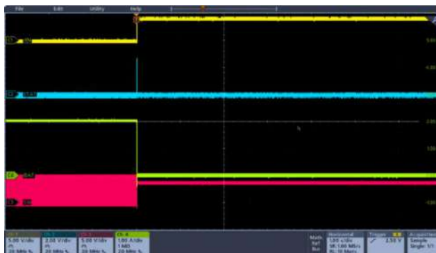
图 10-4 由 EN 管脚触发的充电禁止 V_{BUS} = 5V , V_{BAT} = 3.7V , ICHG = 2A
