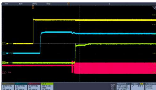
图 10-1 由 VBUS 触发的充电启动 V_{BUS} = 5V , V_{BAT} = 3.7V , ICHG = 2A
