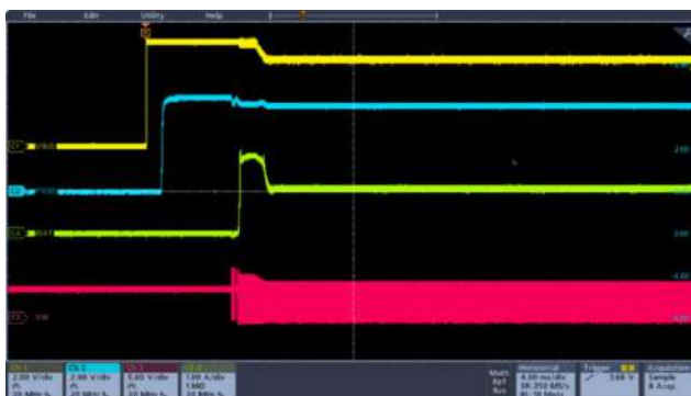
图 10-6 上电时进入 VINDPM VBAT = 3.7V, ICHG = 2A, 插入 5V/1A VBUS
